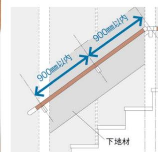
丸棒手すりは木製を採用しており、ブラケットの取り付け間隔は最長900mmまで可能。
