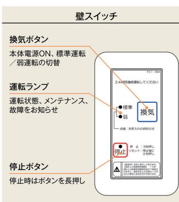
※壁スイッチの中継コードの最大長さは7mになります。壁スイッチの設置位置はコードの届く範囲内となります。
