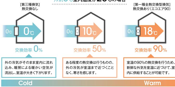
一般的な第三種換気は、冬場の外気が0°Cであれば、暖房された室内に0°Cの冷気を取り込んでしまいます。しかし、熱交換換気の場合は、外に排気する空気の熱を活用し、室内温度に近づけて給気するため熱ロスが少なく、快適性が保たれます。
